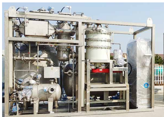
超重力碳捕集系统 150m 3 /h 小型装置与测试平台
